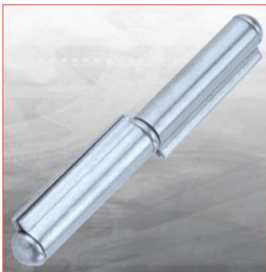
CERNIERA TRANCIATA A TAPPO 2 ALI, PERNO CON RONDELLA FISSA IN ACCIAIO ZINCATO
