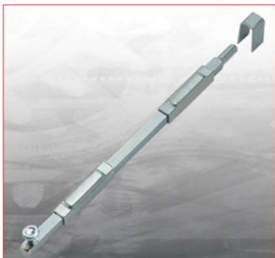
CATENACCIO VERTICALE 10x10 CON PUNTA TONDA, ZINCATO
